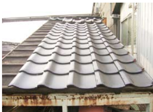
■ 瓦屋根の水密試験体
